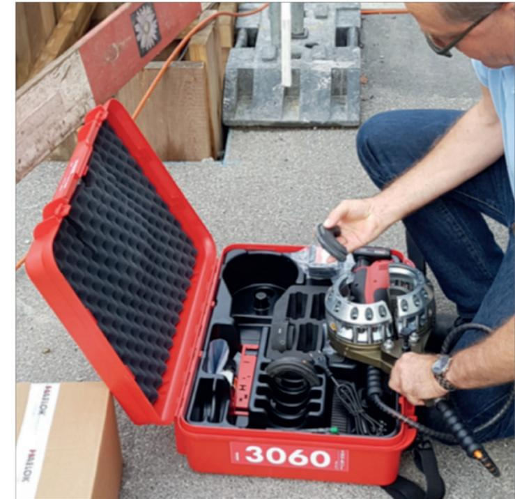
Bild 2. Mit dem Presswerkzeug wird jede Verpressung per Knopfdruck mit gleichbleibender Qualität realisiert
