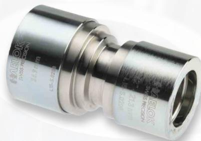
Das HAELOK® THERMO-Fitting «RE» (Reducer) wird für eine gerade Verbindung von zwei Fernwärmerohren mit unterschiedlichen Durchmessern benutzt. Es ist speziell optimiert auf hohe Auszugskräfte, Temperaturwechsel und für den Einsatz nach den aktuellen Vorgaben der AGFW FW 449. Das Fitting besteht aus insgesamt drei fix montierten Bauteilen; einem Grundkörper und zwei Pressringen verschiedener Grössen.
