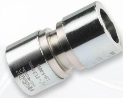
Das HAELOK®- Fitting, Typ «SF» (Straight Fitting), wird für eine gerade Verbindung von zwei Röhren benutzt. Das Fitting besteht aus insgesamt drei fertig montierten Bauteilen; einem Grundkörper und zwei Pressringen.
