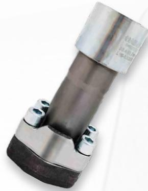
Das HAELOK®- Fitting, Typ «FS» (SAE Flansch), wird für eine gerade Verbindung mit einem Gegenflansch verwendet. SAE Flansche nach DIN ISO 6162-1 (Code 61) Druckklasse 3000 PSI / 207 bar. Die Flansche werden mit O-Ring und zwei Halbflanschen geliefert. Halbflansche können nur mit Verbindungsplatte untereinander verbunden werden. Der Vorteil dieser Verbindung liegt in der frei drehbaren Montage.
