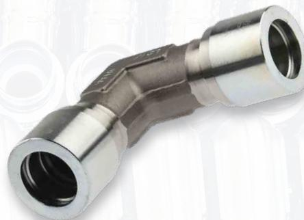
Das HAELOK®- Fitting, Typ «L90» (Winkelstück), wird für eine Verbindung zwischen zwei Rohren im Winkel 90° verwendet. Das Fitting besteht aus insgesamt drei fix montierten Bauteilen; einem Grundkörper und zwei Pressringen. Sonderanfertigungen mit ungleichen Abgängen sind möglich.
