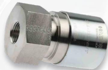
Das HAELOK®- Fitting, Typ «TI» (Thread Internal), wird zum Anschliessen von Armaturen oder Löschdüsen benutzt. Das Fitting besteht aus insgesamt zwei fix montierten Bauteilen; einem Grundkörper und einem Pressring. Sonderanfertigungen mit Spezialgewinde z.B. NPT sind möglich.
