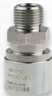
Das HAELOK®- Fitting, Typ «TE» (Thread External), wird zum Anschliessen von Armaturen wie Pumpen oder Ventilen oder benutzt. Generell wird das Gewinde nach Typ «B» mit Dichtkante gefertigt. Für ausgewählte Grössen ist auch Typ «E» mit Viton-Dichtring lieferbar. Das Fitting besteht aus insgesamt zwei fix montierten Bauteilen; einem Grundkörper und einem Pressring.
