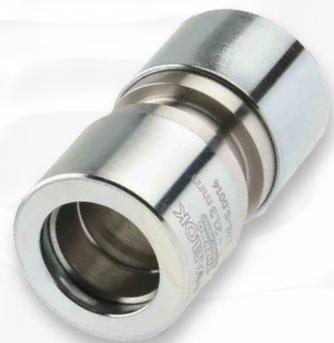
Das HAELOK® THERMO-Fitting «SR» (Straight Repair Fitting) wird für eine gerade Verbindung von zwei Fernwärmehohröhren benutzt. Das Fitting kann über das ganze Rohr verschoben werden um Reparaturen auszuführen. Es ist speziell optimiert auf hohe Auszugskräfte, Temperaturlastwechsel und für den Einsatz nach den aktuellen Vorgaben der AGFW FW 449. Das Fitting besteht aus insgesamt drei fix montierten Bauteilen; einem Grundkörper und zwei Pressringen.
