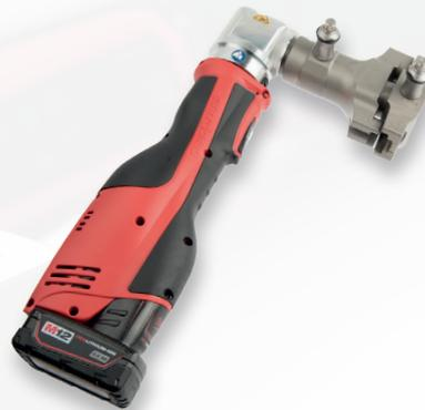
Das Presswerkzeug besteht aus einem hart eloxierten Gehäuse sowie einem wartungsfreien Schliessmechanismus. Die akkubetriebene Hydraulikeinheit entspricht dem letzten Stand der Technik und garantiert eine einwandfreie und sorglose Installation in jeder Situation. Durch das einfache Drehen der Hörner, kann das Presswerkzeug den Bereich von 6 mm bis 13 mm abdecken. Alle HAELOK®- Presswerkzeuge sind geprüft und CE-konform.
