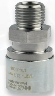
Das HAELOK® -Fitting, Typ «TE» (Thread External), wird zum Anschliessen von Armaturen wie Pumpen oder Ventilen benutzt. Das Gewinde wird nach ISO 228-1 mit Einschraubzapfen Typ «B», also mit Dichtkante, nach ISO 1179-4 gefertigt. Das Fitting besteht aus insgesamt zwei fix montierten Bauteilen; einem Grundkörper und einem Pressring. Sonderanfertigungen mit Spezial- gewinde z.B. NPT sind möglich.
