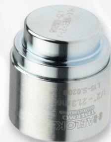
Das HAELOK® THERMO®-Fitting, Typ «EC» (End Cap), wird als Fernwärmerohrabschluss verwendet. Es ist speziell optimiert auf hohe Auszugskräfte, Temperaturwechsel und für den Einsatz nach den aktuellen Vorgaben der AGFW FW 449. Das Fitting besteht aus insgesamt zwei fix montierten Bauteilen; einem Grundkörper und einem Pressring.
