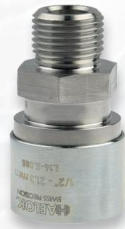
Das HAELOK® -Fitting, Typ «TE» (Thread External), wird zum Anschliessen von Armaturen wie Pumpen oder Ventilen benutzt. Das Gewinde wird nach ISO 228-1 mit Einschraubzapfen Typ «B», also mit Dichtkante, nach ISO 1179-4 gefertigt. Das Fitting besteht aus insgesamt zwei fix montierten Bauteilen; einem Grundkörper und einem Pressring. Sonderanfertigungen mit Spezial- gewinde z.B. NPT sind möglich.
