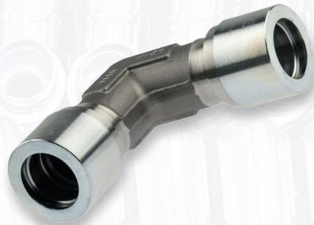
Das HAELOK®- Fitting, Typ «L90» (Winkelstück), wird für eine Verbindung zwischen zwei Rohren im Winkel 90° verwendet. Das Fitting besteht aus insgesamt drei fix montierten Bauteilen; einem Grundkörper und zwei Pressringen. Sonderanfertigungen mit ungleichen Abgängen sind möglich.
