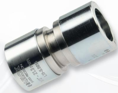
Das HAELOK®- Fitting, Typ «SF» (Straight Fitting), wird für eine gerade Verbindung von zwei Rohren benutzt. Das Fitting besteht aus insgesamt drei fix montierten Bauteilen; einem Grundkörper und zwei Pressringen.
