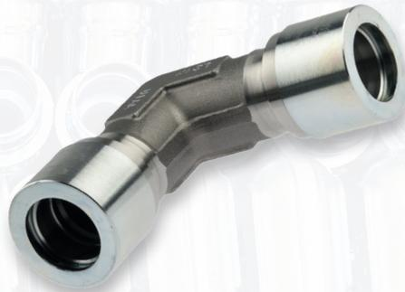
Das HAELOK®- Fitting, Typ «L90» (Elbow), wird für eine Verbindung zwischen zwei Röhren im Winkel 90° verwendet. Das Fitting besteht aus insgesamt drei fix montierten Bauteilen; einem Grundkörper und zwei Pressringen. Sonderanfertigungen mit ungleichen Abgängen sind in Grenzen möglich.
