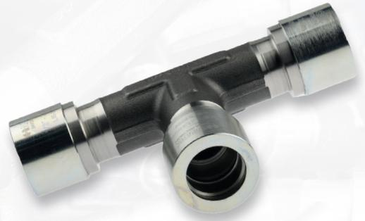
Das HAELOK®- Fitting, Typ «T3» (Equal-T), wird als Verbindung zwischen drei Röhren benutzt. Das Fitting besteht aus insgesamt vier fix montierten Bauteilen; einem Grundkörper und drei Pressringen. Sonderanfertigungen mit ungleichen Abgängen (TR/T-reduziert) sind in Grenzen möglich.
