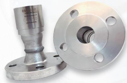
Das HAELOK®- Fitting, Typ «FD» (DIN-Flansch), ist eine lösbare Verbindung zu Ventilen, Pumpen und Tanks. Wir bieten ab Lager PN40 Flanschverbindungen nach DIN 2633. Die Standardgrößen reichen von DN 20 bis DN 50. Die Flansche werden ohne Dichtungen und Verbindungsmittel geliefert. Das Lochbild passt ebenfalls zu Flanschen der Reihe PN16 und PN25.
