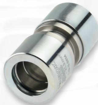
Das HAELOK® THERMO®-Fitting «SR» (Straight Repair Fitting) wird für eine gerade Verbindung von zwei Fernwärmehohrbenutzt. Das Fitting kann über das ganze Rohr verschoben werden um Reparaturen auszuführen. Es ist speziell optimiert auf hohe Auszugskräfte und Temperaturlastwechsel. Das Fitting besteht aus insgesamt drei fix montierten Bauteilen; einem Grundkörper und zwei Pressringen.
