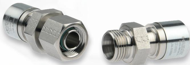
Das HAELOK®- Fitting Typ «CM / CF» (DKO), wird als lösbare Verbindung von zwei Rohren oder zum Anschluss von Hydraulikschläuchen oder Löschdüsen benutzt. DKO nach DIN EN ISO 8434-1 Series S. CM bezeichnet den Konus mit Überwurfmutter, CF den Konus mit Aussengewinde als Gegenstück. Das Fitting besteht aus mehreren fest verbauten Teilen.
