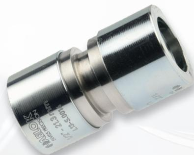
Das HAELOK®- Fitting, Typ «SF» (Straight Fitting), wird für eine gerade Verbindung von zwei Röhren benutzt. Das Fitting besteht aus insgesamt drei fertig montierten Bauteilen; einem Grundkörper und zwei Pressringen.
