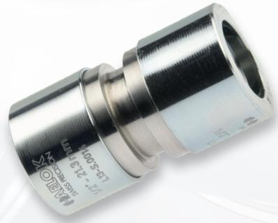
Das HAELOK®-Fitting, Typ «SF» (Straight Fitting), wird für eine gerade Verbindung von zwei Rohren benutzt. Das Fitting besteht aus insgesamt drei fix montierten Bauteilen; einem Grundkörper und zwei Pressringen.
