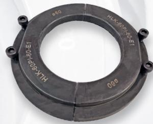
Für die Presstools PT1228, PT3060 & PT76114 sind Werkzeugeinsätze für die Flanschgrößen  $\varnothing 12$  mm bis 114 mm erhältlich. Somit kann ein weiterer Einsatzbereich mit nur einem Werkzeug abgedeckt werden. Die HAELOK®-Werkzeugeinsätze aus gehärtetem Stahl werden magnetisch im Werkzeug festgehalten.
