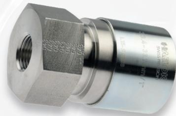
Das HAELOK®- Fitting, Typ «TI» (Thread Internal), wird zum Anschliessen von Armaturen oder Löschdüsen benutzt. Das Innengewinde wird nach Norm ISO 228-1 (zylindrisch parallel) mit einer Einschraubbohrung nach Norm ISO 1179-1 gefertigt. Das Fitting besteht aus insgesamt zwei fix montierten Bauteilen; einem Grundkörper und einem Pressring. Sonderanfertigungen mit Spezialgewinde z.B. NPT sind möglich.
