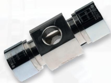
Das HAELOK®- Fitting, Typ «D2» (Distributor 2 Outlets), besitzt zwei seitliche Abgänge mit G ½" Gewinde und kann als Messstelle oder zum einschrauben von Löschdüsen verwendet werden. In Verbindung mit Gewindeteilen TE\_\_-G12\_ kann leicht ein Abgang oder Kreuzstück realisiert werden. Das Fitting besteht aus insgesamt drei fix montierten Bauteilen; einem Grundkörper und zwei Pressringen.
